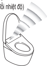
Cảm biến loại B (Phát hiện khi có người đứng trước lòng bồn cầu.)
