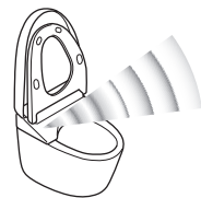
Cảm biến loại B (Phát hiện khi có người đứng trước lòng bồn cầu.)
